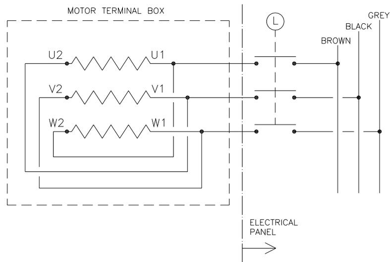
FIGURE 3 DOL MOTOR STARTER
